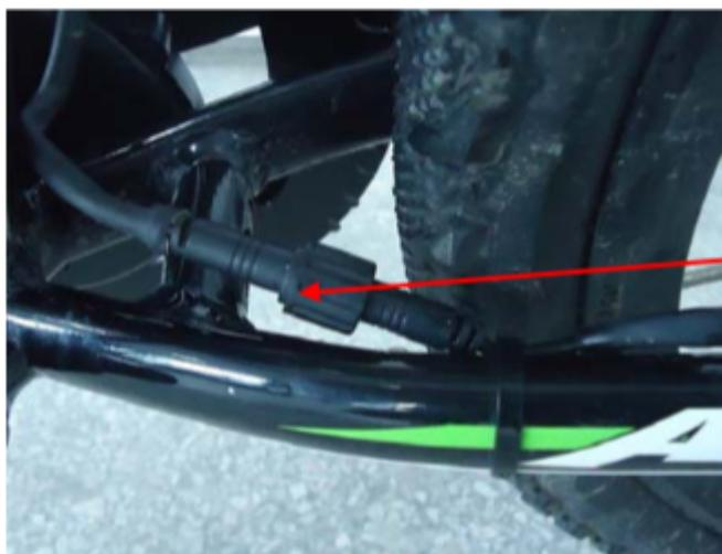
conector do sensor de velocidade
