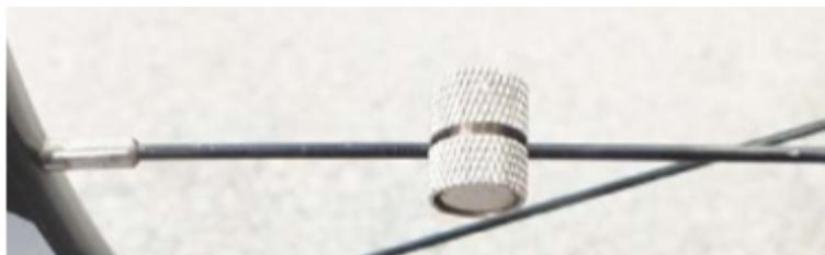
Perceba que o ímã deve ficar paralelo ao sensor de velocidade. Ajuste a distância entre o ímã e o sensor para que não ultrapasse 5mm.
