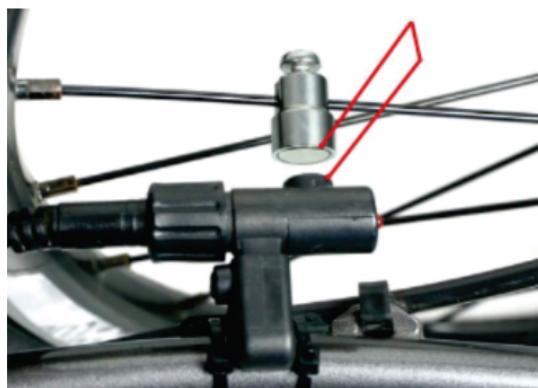
O erro 21 é normalmente muito fácil de corrigir porque é comum que o ímã que impressiona o sensor de velocidade, fique mal posicionado. Para resolver, basta reposicioná-lo conforme a imagem.
